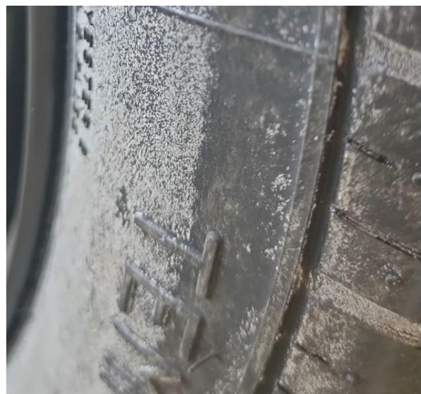
Abbildung 28 Durch Verformung ausgetretene Alterungsschutzmittel eines Reifens
